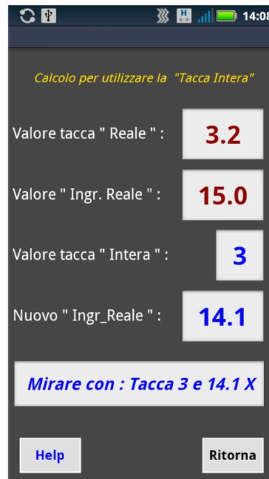
Per un tiro a 360 metri il programma ha calcolato una correzione di 3.2 tacche balistiche usando l’ingrandimento 15x ( che è il valore massimo ... )
